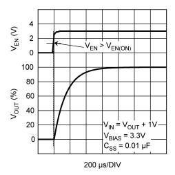
Figure 4. V<sub>OUT</sub> Soft-Start
