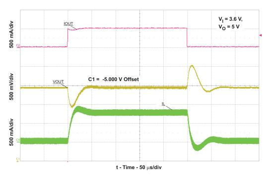
Figure 6. Voltage-Mode Load Transient
