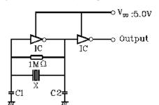
X: Ceramic Resonator C1=C2: 10pF ±20% (20.00MHz~25.99MHz)  $5pF \pm 20\% (26.00MHz \sim 35.00MHz)$  $5pF \pm 20\% (35.01MHz \sim 60.00MHz)$
