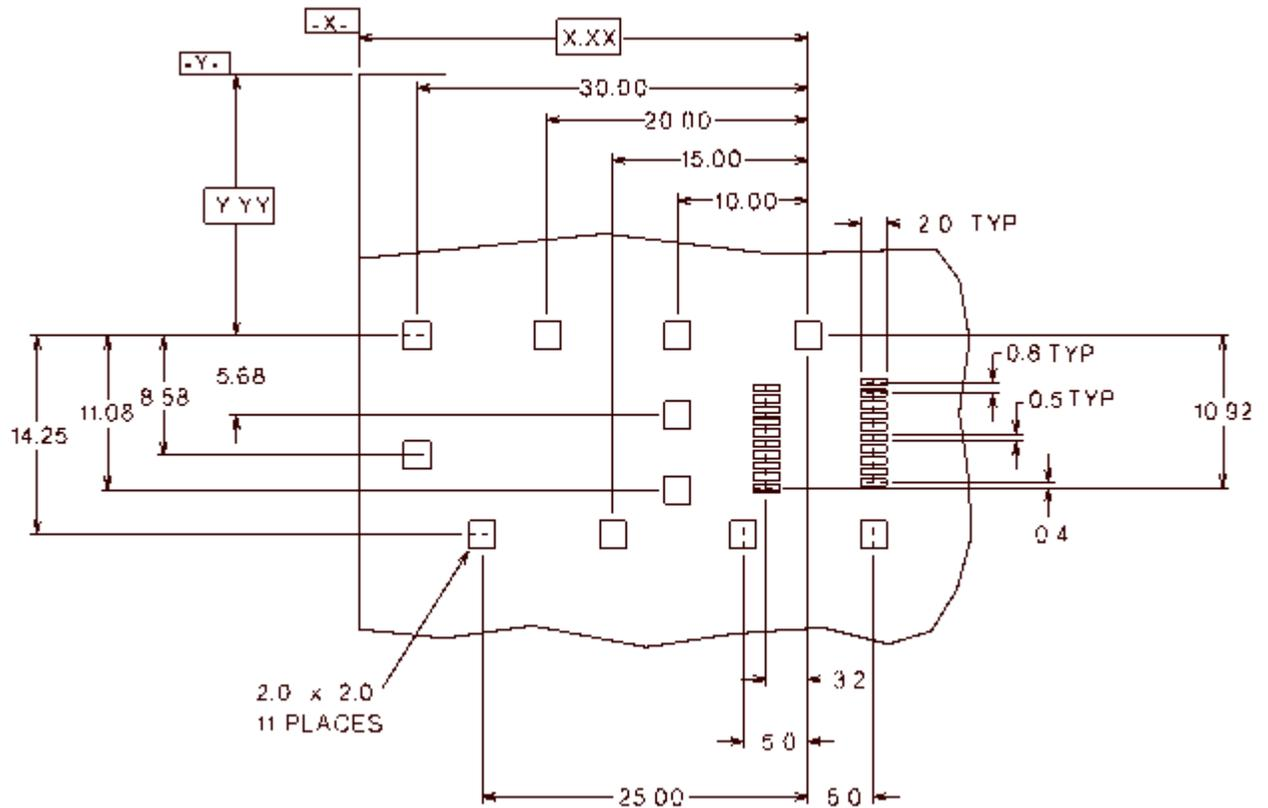
**FIGURE 1: RECOMMENDED STENCIL LAYOUT**
