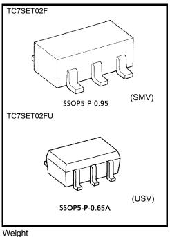
SSOP5-P-0.95 : 0.016 g (typ.) SSOP5-P-0.65A : 0.006 g (typ.)
