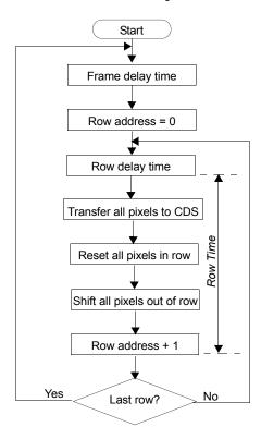
Figure 17. Frame Readout Flow Diagram
